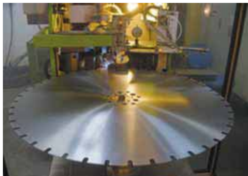
Soudure laser pour les grands diamètres (ø 800 à 1200 mm)
