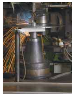
Soudure laser pour les diamètres courants
