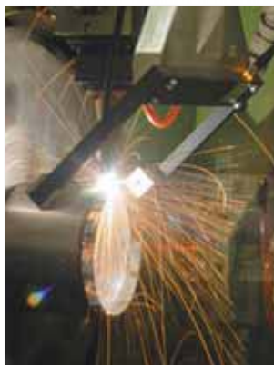
Soudure laser pour les couronnes
