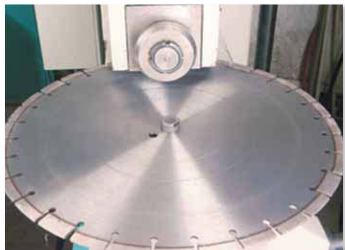
Contrôle de tension de tôle
